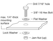
**NEVER TIGHTEN** BY TURNING THE TRANSDUCER. MAKE SURE TO **TIGHTEN THE JAM NUT AGAINST THE** TRANSDUCER'S **BRASS NUT.**
